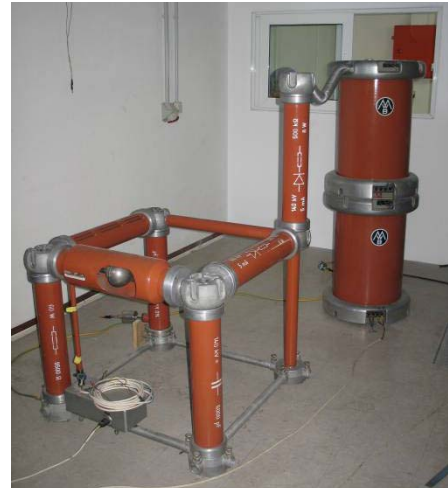
Σχήμα 2.3 Ανόρμη μονοβάθμια κρουστική γεννήτρια.
