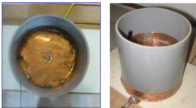
Σχήμα 2.7 Διάταξη παραλλήλων πλακών.
