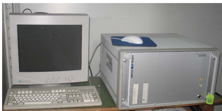
Σχήμα 2.6 Ψηφιακό σύστημα καταγραφής κρουστικών τάσεων Heafely DIAS 733.
