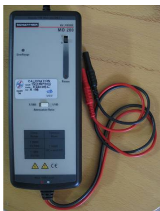
Σχήμα 2.8 Διαφορικός καταμεριστής Schaffner MD200.
