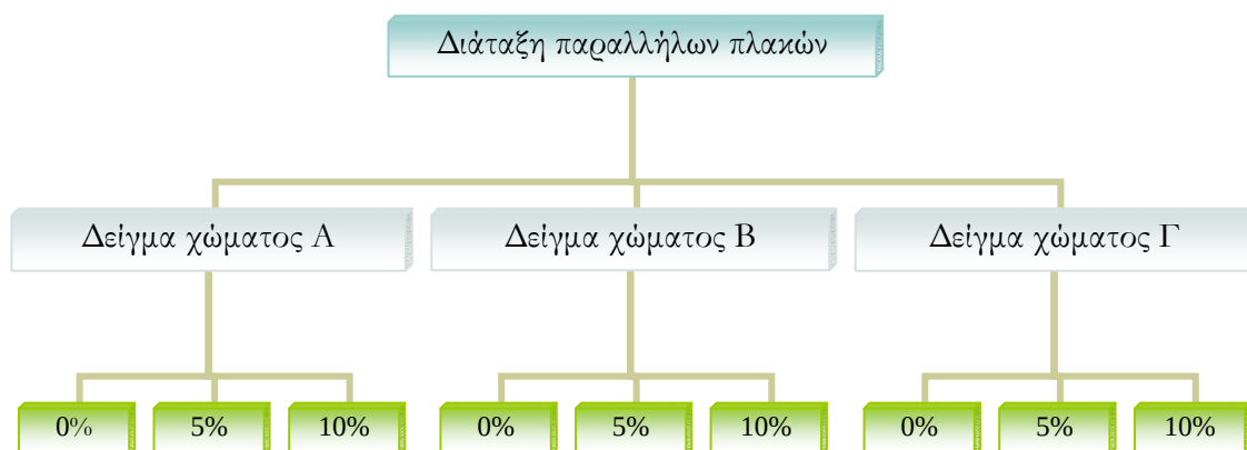
Σχήμα 2.13 Δοκιμές διάσπασης, με τη χρήση της διάταξης παραλλήλων πλακών, για τα εδαφικά δείγματα Α, Β και Γ και περιεκτικότητα σε υγρασία 0%, 5% και 10%.
