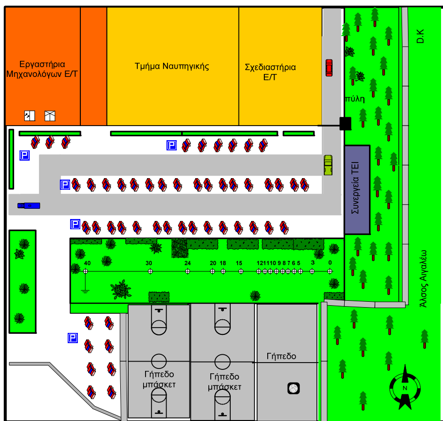
Σχήμα 2.15 Χώρος πραγματοποίησης των μετρήσεων (οι αριθμοί 3...40 αντιπροσωπεύουν την απόσταση a του ηλεκτροδίου από το σημείο αναφοράς 0) [2.9].
