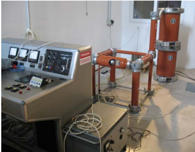
Σχήμα 2.3 Ανόρμη μονοβάθμια κρουστική γεννήτρια.
