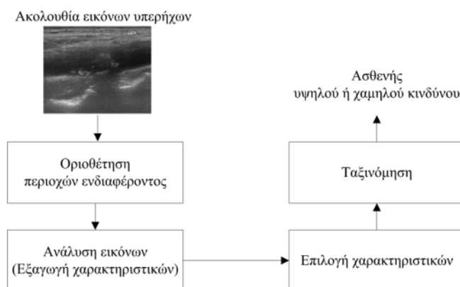
Σχήμα 1.9: Διάγραμμα ροής της λειτουργίας ενός συστήματος υποβοηθούμενης διάγνωσης, βασιζόμενου στην υπολογιστική ανάλυση εικόνων υπερήχων για την αξιολόγηση της επικινδυνότητας της καρωτιδικής αθηρωμάτωσης.
