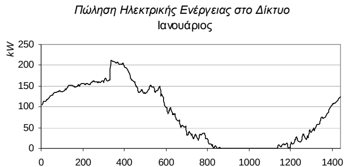
Σχήμα 2.13.μ. Σενάριο 2 ο . Πώληση Της Πλεονάζουσας Ηλεκτρικής Ενέργειας Στο Δίκτυο Διανομής.
