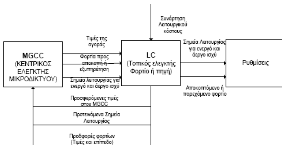
Σχήμα 4.5.β. Η Ροή Πληροφορίας Μεταξύ Του Κεντρικού Ελεγκτή Και Των Τοπικών Ελεγκτών Σε Ένα Μικροδίκτυο, [35].
