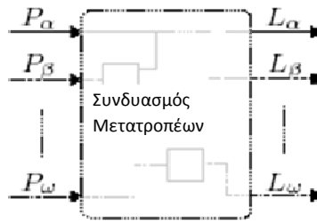
Σχήμα Π.4.Δ.1.δ. Σύμπλεγμα Μετατροπών Με Πολλαπλές Εισόδους Και Εξόδους.
