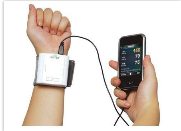
Εικόνα 2.13: Εφαρμογή έξυπνου τηλεφώνου, η οποία με την βοήθεια του κατάλληλο εξαρτήματος μετράει την αρτηριακή πίεση του ασθενή. [25]
