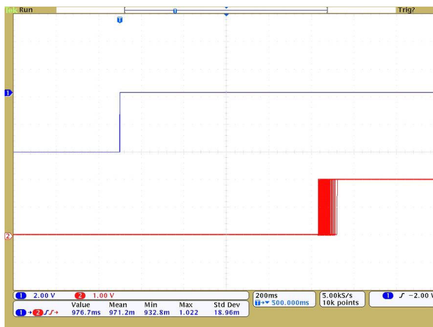
Γράφημα 39. Μέτρηση καθυστέρησης εγκατάστασης κλήσης LAN_CSD.3
