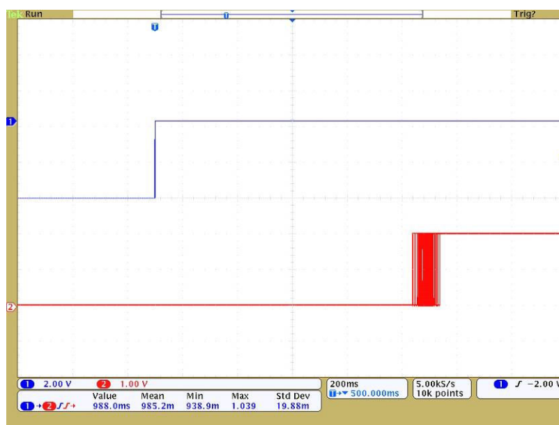
Γράφημα 38. Μέτρηση καθυστέρησης εγκατάστασης κλήσης LAN_CSD.2
