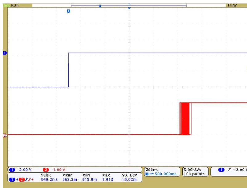
Γράφημα 37. Μέτρηση καθυστέρησης εγκατάστασης κλήσης LAN_CSD.1
