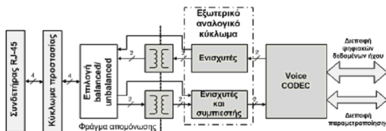
Σχήμα 23. Αρχιτεκτονικό διάγραμμα της θύρας ήχου
