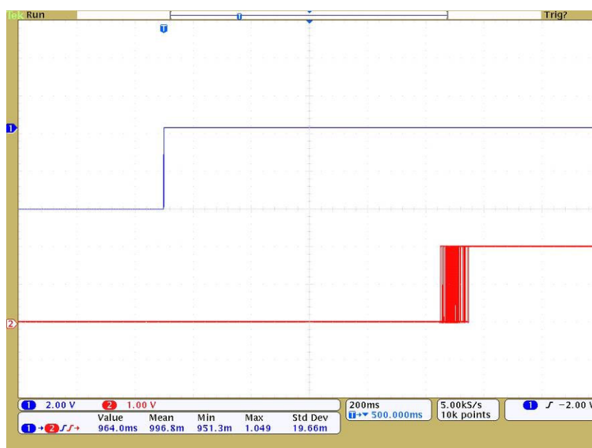
Γράφημα 40. Μέτρηση καθυστέρησης εγκατάστασης κλήσης LAN_CSD.4
