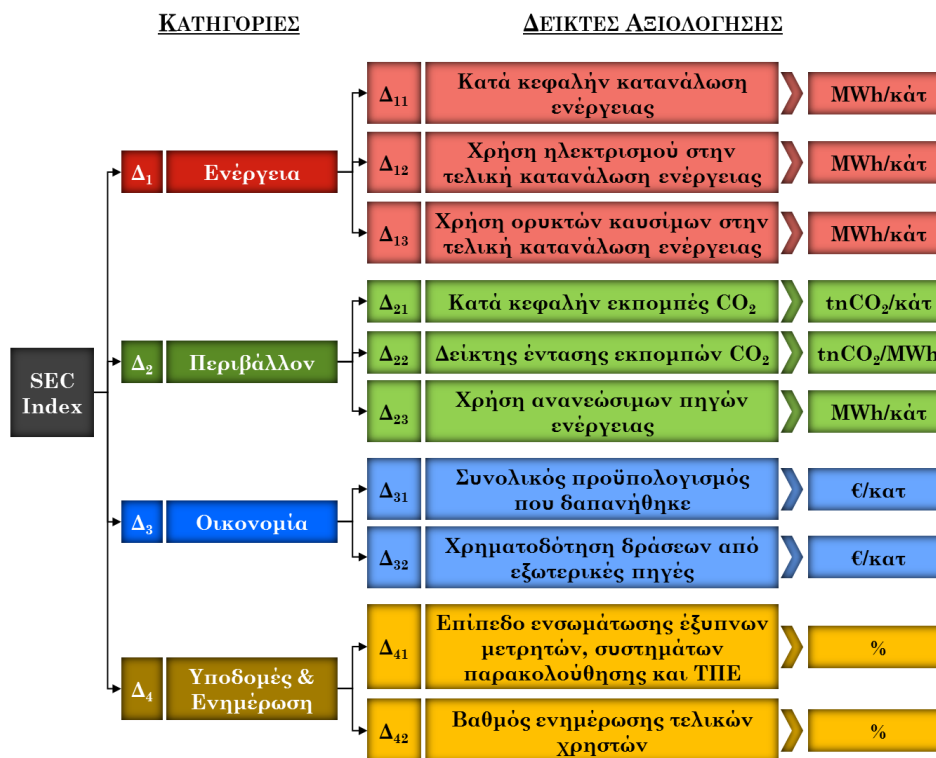
Σχήμα 4.17. Πλαίσιο Ελέγχου Στόχων Ενεργειακά Βιώσιμων Κοινοτήτων
