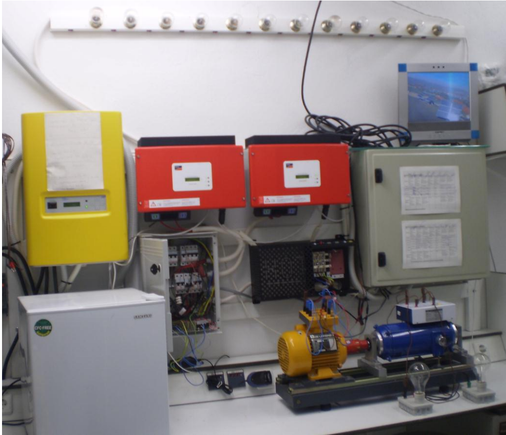
Σχήμα 3.2. Sunny Island 3324 αντιστροφέας (κίτρινος), δύο αντιστροφείς διασύνδεσης (κόκκινοι) και φορτία: ψυγείο, κινητήρας και 12 λάμπες πυρακτώσεως
