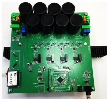
Σχήμα 3.21. Πρωτότυπος αντιστροφέας για οδήγηση IPTS.
