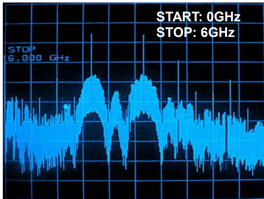
Εικόνα 94: Ηλεκτρικό φάσμα μετά από προβιβασμό συχνότητας των δύο σημάτων και συνδυασμό τους.
