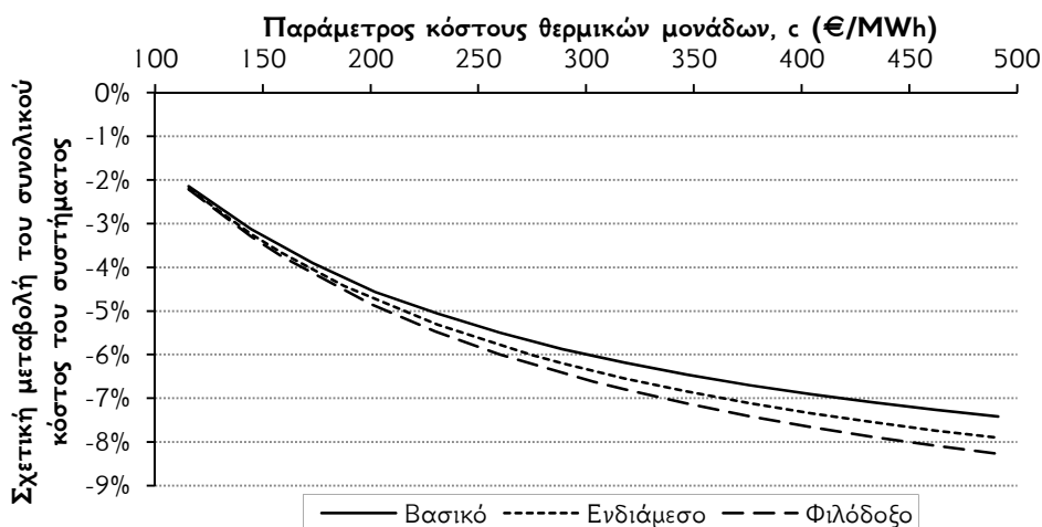
Διάγραμμα 6.7: Σχετική μείωση του συνολικού κόστους του συστήματος για διαφορετικές τιμές της παραμέτρου c ανά σενάριο φορτίου.
