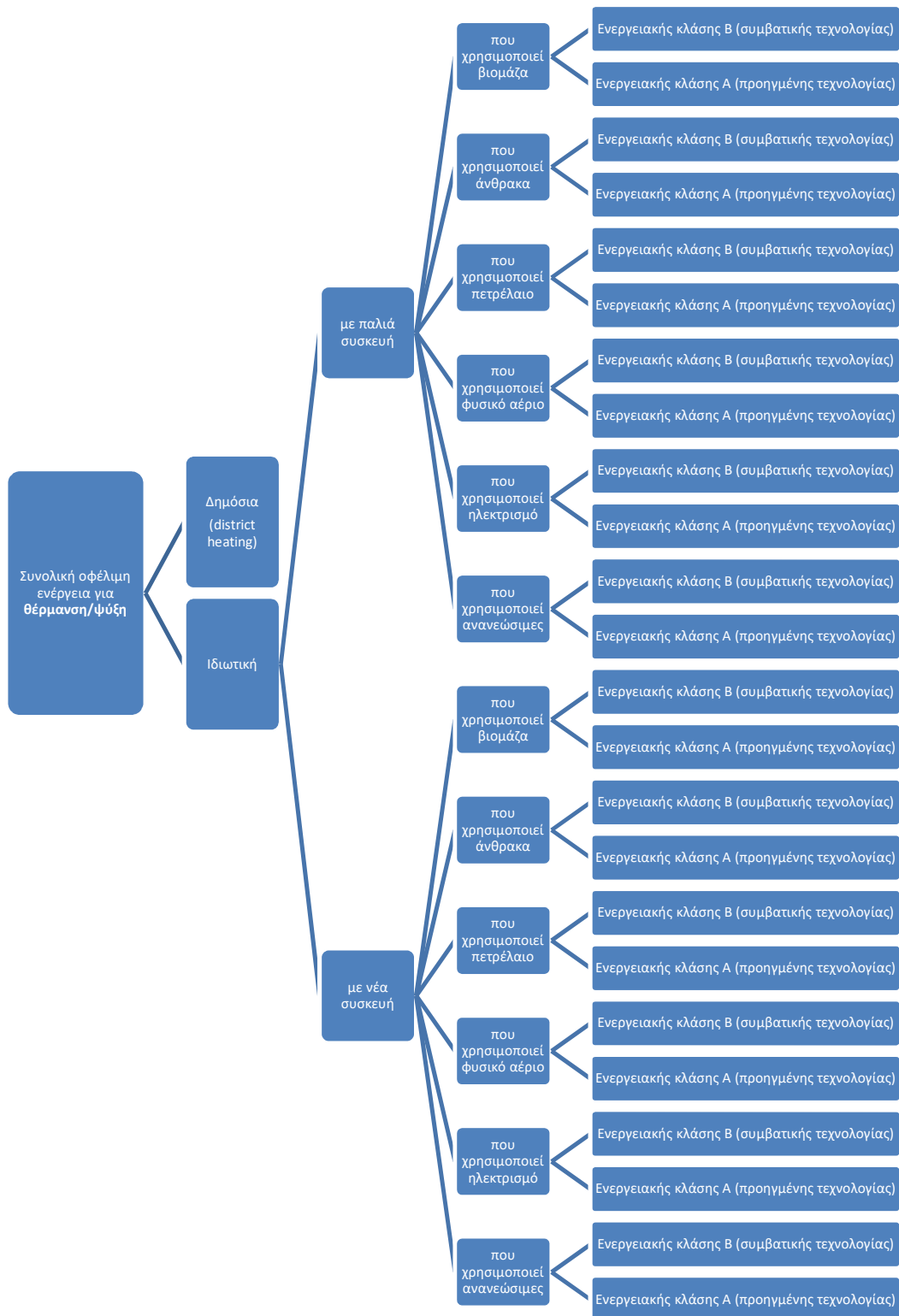
Σχήμα 5-4: Δέντρο απόφασης του νοικοκυριού για θέρμανση/ψύξη
