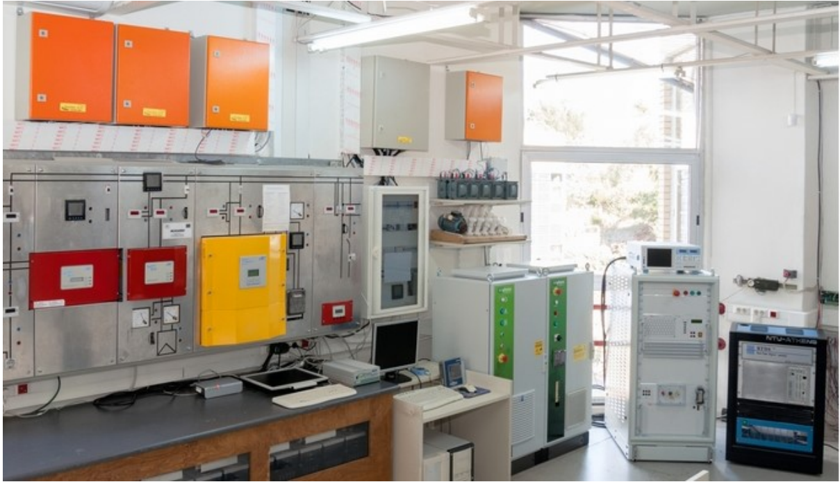
Σχήμα 4.1. Το μονοφασικό μικροδίκτυο, ο διακοπτόμενος ενισχυτής ισχύος, ο γραμμικός ενισχυτής ισχύος και ο ΨΠΙΧ (RTDS ® ) του εργαστηρίου ΣΗΕ (αριστερά προς τα δεξιά)
