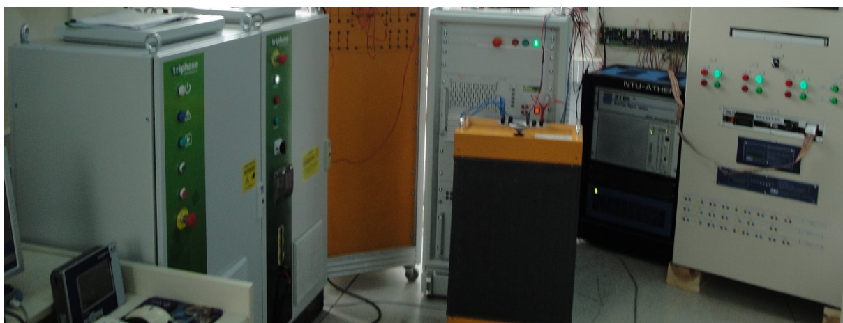
Σχήμα 6.3. Εκτέλεση των εργαστηριακών ασκήσεων: διακοπτόμενος ενισχυτής, ομοίωμα γραμμής, γραμμικός ενισχυτής, φορτίο, ΨΠΠΧ, ψηφιακός ηλεκτρονόμος (αριστερά προς τα δεξιά)
