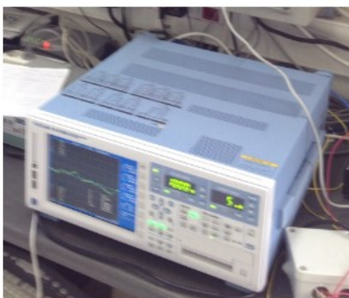
Σχήμα 7.13. Αναλυτής ισχύος (Yokogawa) που επιτρέπει τη μέτρηση υψίσυχων αρμονικών ρεύματος αντιστροφών
