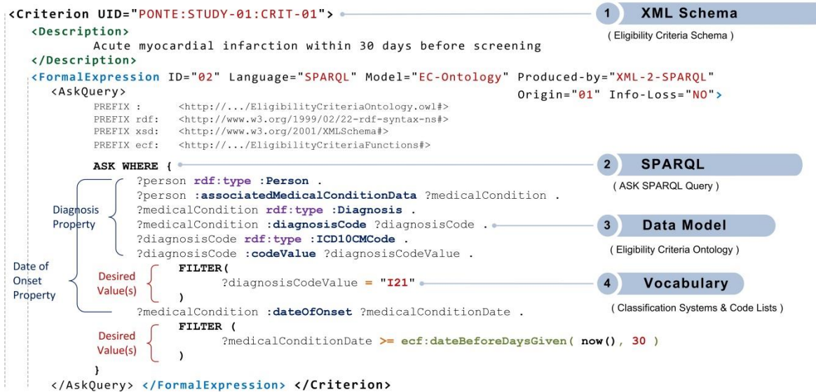
Σχήμα 6: Κριτήριο σχετικό με τις διαγνώσεις ενός ασθενούς, τυπικά εκφρασμένο σε SPARQL.
