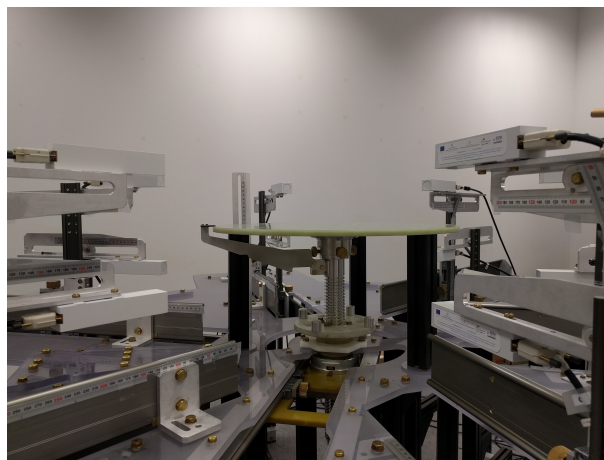
ΣΧΗΜΑ 4.7: Διάταξη με 12 μαγνητόμετρα και ακτίνα r = 20 cm.
