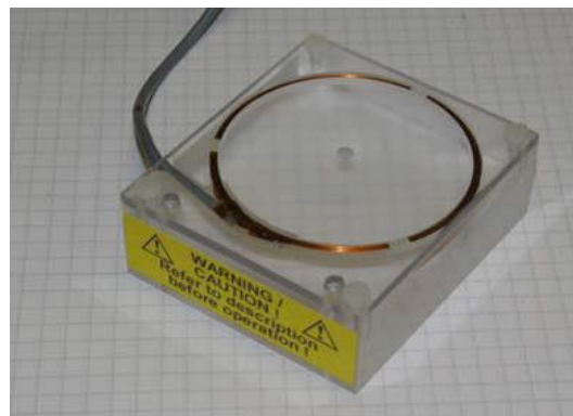
ΣΧΗΜΑ 5.16: Πηνίο τροφοδοτούμενο από ρεύμα.
